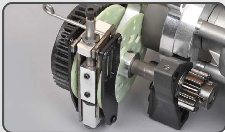
Doppelte Antriebs-Scheibenbremse Double disk transmission brake Frein de transmission double disques Best.-Nr./ Item N°./ Réf. 08447
