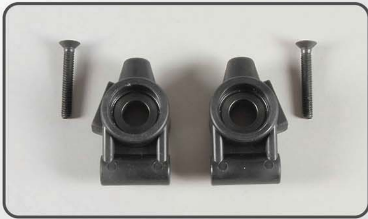
Kunststoff-Achsschenkel hinten links/rechts, 2 St. Plastic upright rear left/right, 2 pcs. Fusées plastique arrière gauche/droite, 2 pcs. Best.-Nr./ Item N°./ Réf. 06430/01
