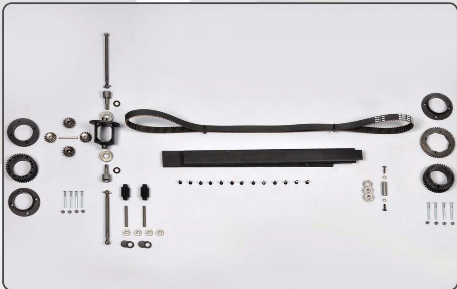
4WD Umrüstsatz für 2WD Fun Cross 4WD Conversion kit for Fun Cross 2WD Kit de conversion 4WD pour Fun Cross 2WD Best.-Nr./ Item N°/ Réf. 68504
