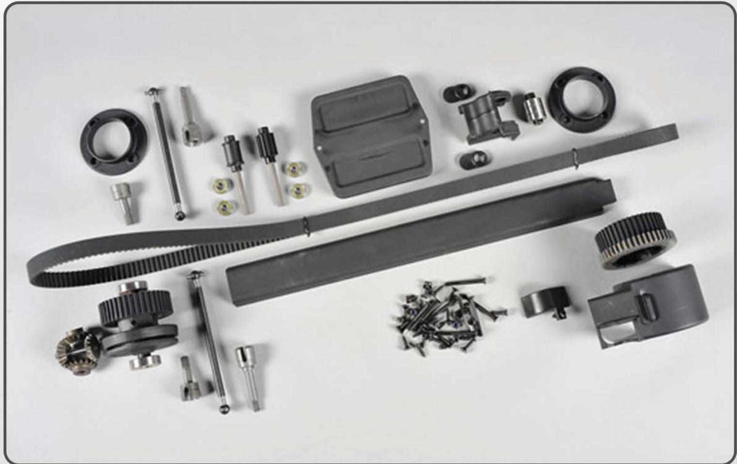
4WD Umrüstsatz für Leopard 2WD 4WD conversion kit for Leopard 2WD Kit de conversion 4WD pour Leopard 2WD Best.-Nr./ Item N°/ Réf. 68503
