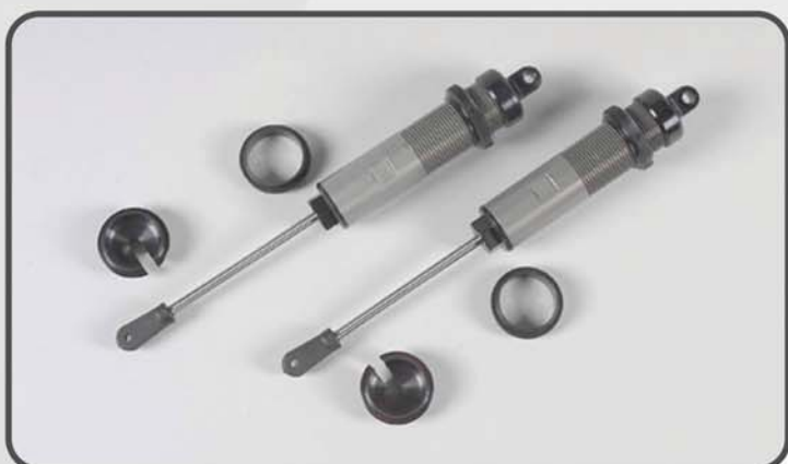
Alu-Stoßdämpfer lang, Ø 24x210mm, 2 St. Alum. damper long, Ø 24x210mm, 2 pcs. Amortisseurs alu longs, Ø 24x210mm, 2 pcs 210mm, 2 pcs. Best.-Nr./ Item N°./ Réf. 67320
